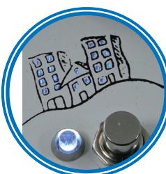
ライト・オーバードライブは、伝説の名機Klon Centaurの回路をベースに、よりユーザーライクな改良を加えたブースター／オーバードライブです。全てのドライブレベルでピュアな透明感に溢れ、各弦の分離が極めて明確なサウンドは、多くのトップギタリストを唸らせた名機に勝るとも劣りません。さらに本機は、シリコンとゲルマニウム2種類のクリッパーダイオードを搭載し、内部のDIPスイッチによりON/OFFが可能。Centaurでは実現できなかった、幅広いサウンドバリエーションを獲得しています。外寸もペダルボードにマッチする、標準的なエンクロージャーへのダウンサイ징に成功。街の灯りをイメージしたLEDのイルミネーションもクールです。最上級のギターとアンプの性能を120%引き出し、ギタリストの表現力をイメージのその先まで拡張する、オーバードライブが辿り着いた到達点のひとつと呼ぶにふさわしい1台です。
