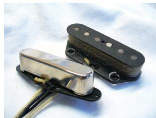
FBG Vintage Soul 50s Tele Pickup Setは、1951～54年に生産されたブラックピックガード期のデレキスターのサウンドをターゲットにしたセット。コイルはFatboy Guitarsが提唱するメソッド「キャバシタンス・ワインディング」によるハンドワインディング。インダクタンス・直流抵抗・磁力などの数値を経年変化したヴィンテージPUと正確に合致させ、枯れた味わい深いサウンドを忠実に再現しています。
