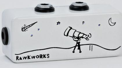
RawkWorksバッファーは、サウンドのピュアさでは定評のあるKlon CentaurのバッファーをM・スキナーが改良し、搭載されていたLIGHT Overdrive Ver.1から独立させた1台です。原音に余計な色付けをすることなくハイインピーダンス信号をローインピーダンスに変換し、複数のエフェクトチェインや長いシールドケーブルによるシグナルロス、高音の欠落、音ヤセを排除します。外装には高耐久性のハモンド製エンクロージャー、ノイトリック製ジャック、内部にはニチコンやXicon、Wimaの高品質・高耐久性パーツを使用するなど、実用面での信頼性にも抜かりはありません。また、どちらか一方のDCジャックから他のペダルに電源供給が可能となっています(DC9V)。
