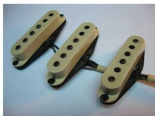
1957~59年のアッシュorアルダーボディ/メイプル指板ストラトキャスターに搭載されていたシングルコイルPUのクローンです。アルニコ5マグネット、バルカンファイバー製ブラックポビン、コイルワイヤーには42AWGヘビー・フォームバー・ワイヤーを使用(ワックス含浸済み)。4弦より3弦が低いスタaggerド仕様のポールピースは、上縁の角を落した0.195インチ径。出力線にはヴィンテージクロスワイヤー、オリジナルと同形状の固定ビスを使用。また、グリーンがかったヴィンテージ・ホワイトのナイロン製PUカバーは、1957~59年に特有の形状や裏面のモールド、射出成型の湯口の跡まで正確に再現。経年変化の渋み溢れるエイジド加工を施しました。直流抵抗値は、Neck = 5.5k Ohm/Middle = 5.75k Ohm/Bridge = 6.0k Ohmとなっています。
