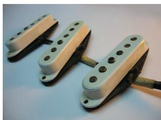
1954~56年のアッシュボディ/メイプル指板ストラトキャスターに搭載されていたシングルコイルPUのクローンです。アルニコ3マグネット、バルカンファイバー製ブラックポビン、コイルワイヤーには42AWGヘビー・フォームバー・ワイヤーを使用(ワックス含浸済み)。4弦より3弦が低いスタaggerド仕様のポールピースは、上縁の角を落した0.195インチ径。出力線にはヴィンテージクロスワイヤー、オリジナルと同形状の固定ビスを使用。また、PUカバーはベークライトを思わせる薄手のプラスチックで、1954~56年に特有のエッジのアーチが緩い形状、裏面のモールドや射出成型の湯口の跡まで正確に再現。経年変化の渋み溢れるエイジド加工を施しました。直流抵抗値は、Neck = 5.25k Ohm/Middle = 5.5k Ohm/Bridge = 5.75k Ohmとなっています。
