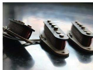
1970年代のラージヘッド、アルダーボディ/メイプルorローズウッド指板ストラトキャスターに搭載されていたシングルコイルPUのクローンです。アルニコ5マグネット、バルカンファイバー製グレーポビン、コイルワイヤーは42AWGプレーンエナメル・ワイヤー、(ワックス含浸済み)ポールピースはフラット仕様。出力線には1970年代初期と同様のホワイト&ブラックのヴィンテージクロスワイヤーと、中期以降のビニール皮膜ワイヤーを用意しました。また、ABS樹脂製PUカバーも、当時の形状や裏面のモールド、射出成型の湯口の跡まで正確に再現。経年変化を思わせるエイジド加工を施しています。直流抵抗値は、Neck = 5.85k Ohm/Middle = 5.85k Ohm/Bridge = 5.85k Ohmとなっています。
