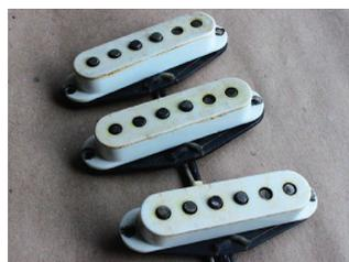
1960年代前半、プリCBS期のアルダーボディ/ローズウッド指板ストラトキャスターに搭載されていたシングルコイルPUのクローンです。アルニコ5マグネット、バルカンファイバー製ブラックポビン、コイルワイヤーには42AWGヘビー・フォームバー・ワイヤーを使用(ワックス含浸済み)。4弦より3弦が高いスタaggerド仕様のポールピースは0.187インチ径。出力線にはヴィンテージクロスワイヤー、オリジナルと同形状の固定ビスを使用。また、1950年代に比べ上縁部のエッジが立ったホワイトのナイロン製PUカバーも、プリCBS期の形状や裏面のモールド、射出成型の湯口の跡まで正確に再現しました。経年変化の渋み溢れるエイジド加工を施しました。直流抵抗値は、Neck = 5.6k Ohm/Middle = 6.0k Ohm/Bridge = 6.4k Ohmとなっています。
